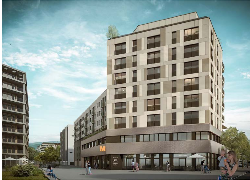
L'ensemble des façades, à l'image de la complexité du projet, se déclinera en deux matérialités: métal déployé de couleur bronze et verre émaillé de différentes teintes.
